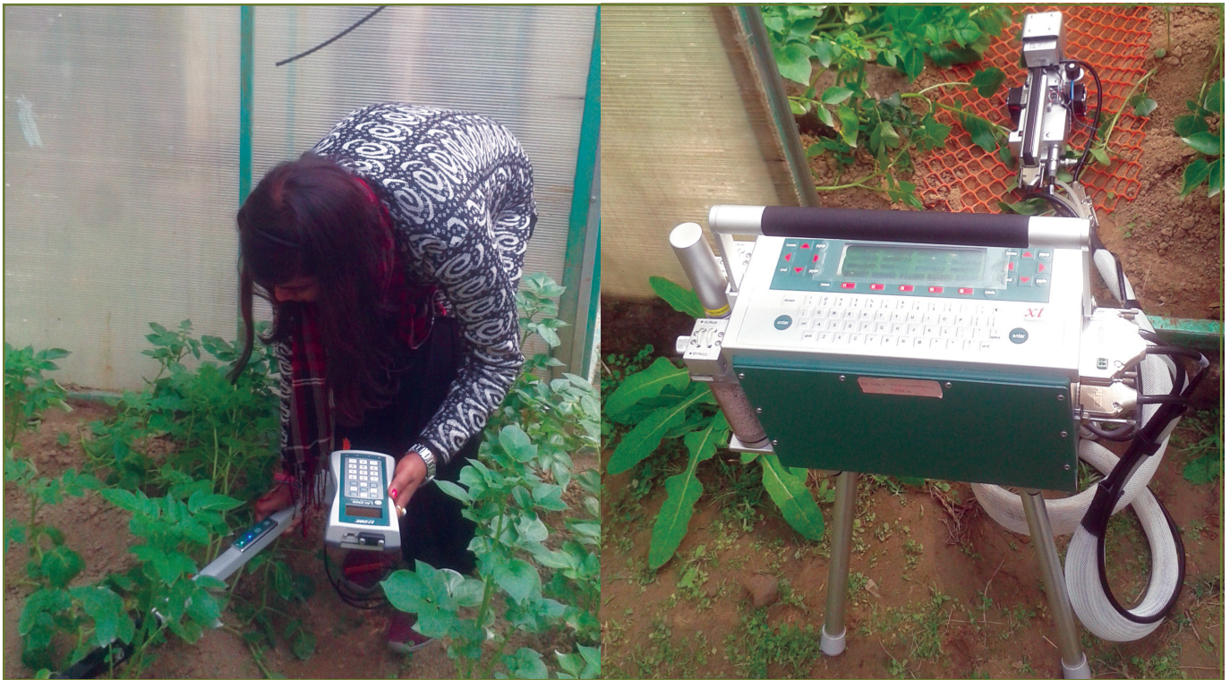
चित्र 2.2 एल.ए.आई. मीटर (बाएं) तथा प्रकाश संश्लेषण मापन का उपयोग कर आलू बागान का जैव भौतिक प्राचल तथा स्पेक्ट्रमी मापन
